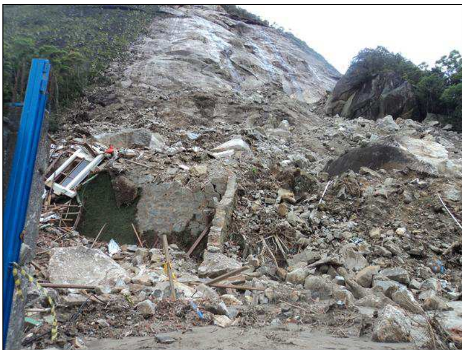
Figura 4: Imagem geral do escorregamento com destaque para o bloco rochoso localizado a direita da cicatriz responsável pela limitação lateral do evento.
