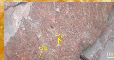
Foto 12: Pedra Madeira Rosa, composto por fitas de quartzo (Qtz) e feldspatos (Fsp). Vista perpendicular à foliação da rocha.
