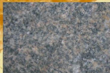
Foto 3: Placa de "Granito Fino". Corte paralelo à foliação da rocha.
