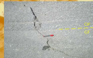
Foto 2: Contato entre "Olho de Pombo" (OP) e "Granito Fino" (GF). Vista perpendicular à foliação. Caneta (13 cm) usada como escala.
